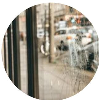
Le film Clear 12 C sécurise vos vitrages et empêche le verre d'éclater en cas de choc, d'explosion ou d'incendie, tout en conservant une parfaite transparence. Parfait pour les grandes surfaces, il est conforme à la norme européenne EN 12600.
